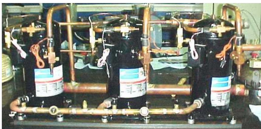
Рис. 2: Параллельная работа спиральных компрессоров
