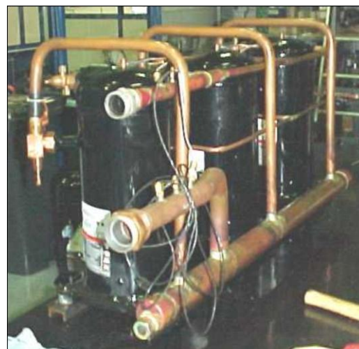
Рис. 4: Конструкция всасывающего коллектора
